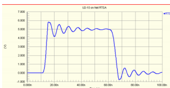
Плохой сигнал (соединение напрямую) и хороший сигнал (с последовательным резистором)
