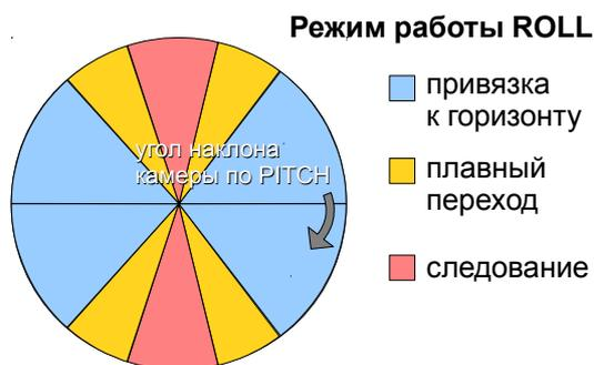
**НА ЗАМЕТКУ:** чтобы полностью отключить следование по ROLL, установите значения параметров (90, 0). Чтобы включить следование по ROLL независимо от угла наклона камеры, установите значения (0, 0)
